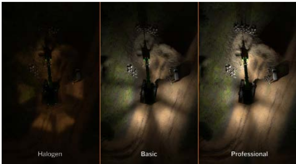
Simulatiebeeld van 9x1000lm halogeenopstelling versus Nordic Lights Basic en Professional lichtplan voor grote graafmachines.
