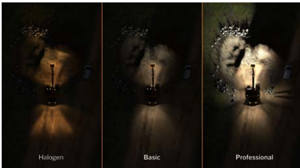
Simulatiebeeld van 7x1000lm halogeenopstelling versus Nordic Lights Basic en Professional opstellingen voor middelgrote graafmachines
